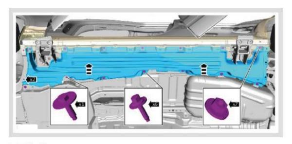
Install the trim. Torque: 8Nm.
